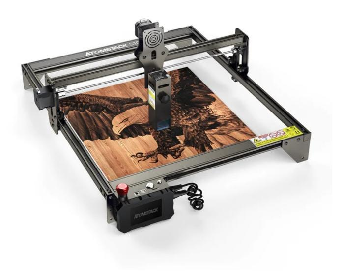
• Construcción ultraligera y duradera: la máquina de grabado pesa solo 4,5 kg y su estructura está hecha completamente de perfiles de aluminio duraderos. Montar todos los elementos de la máquina no lleva más de 15 minutos. Se puede mover libremente de un lugar a otro y el área de trabajo es de hasta 400x400 mm, lo que brinda un amplio abanico de posibilidades a la hora de realizar proyectos.
