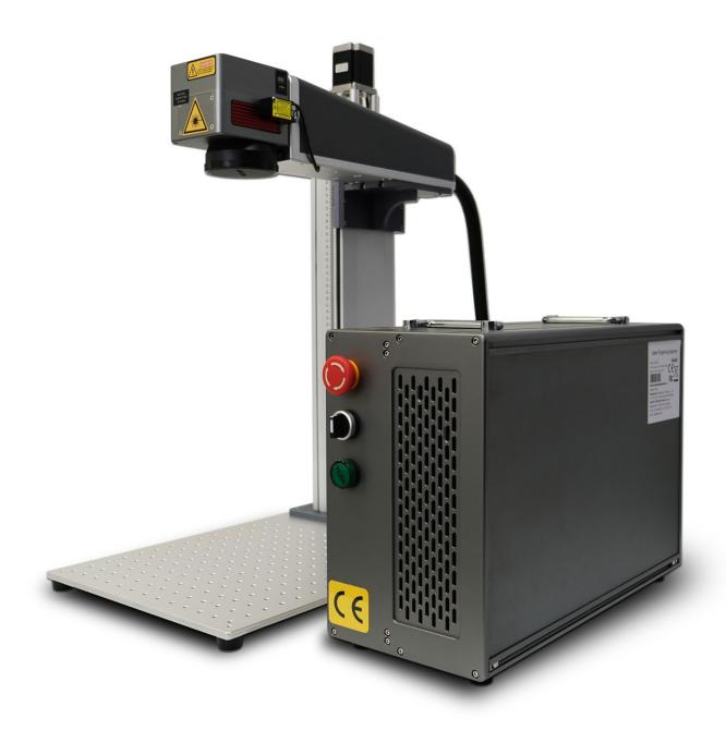
El último modelo de grabador láser FIBER 50W con AUTOFOCO - ya no es necesario ajustar manualmente el enfoque en relación al material - este grabador lo hace automáticamente.
