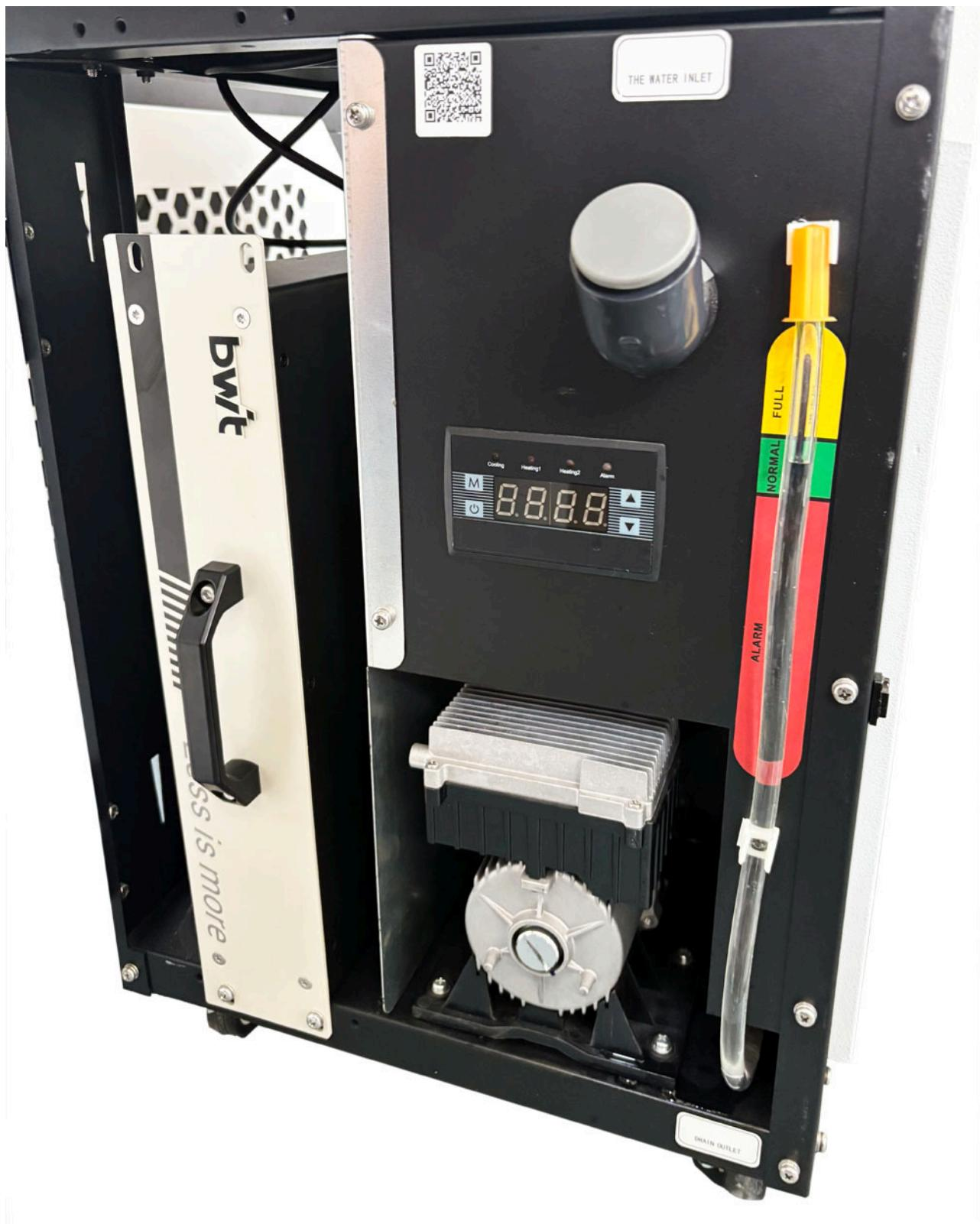
**Refrigerador industrial eficiente integrado en la máquina**
