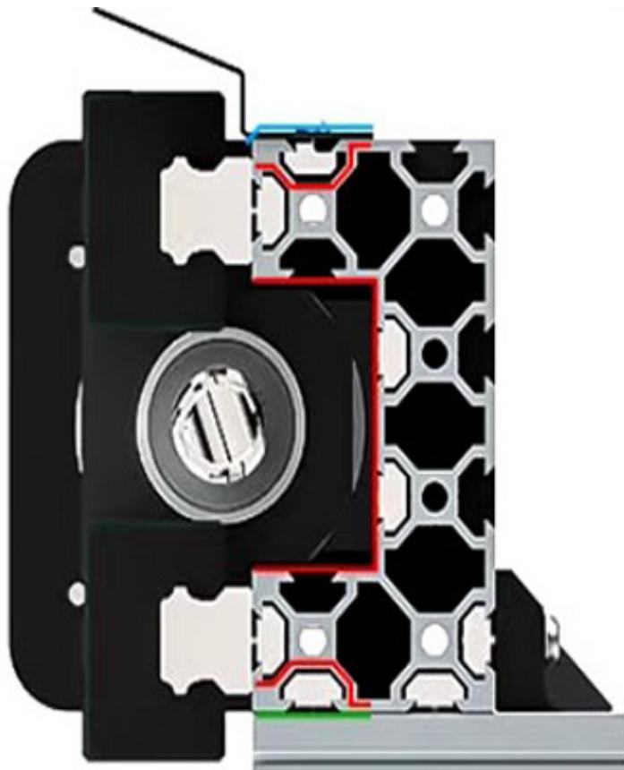
Los orificios de montaje en los perfiles están dispuestos estrechamente, no solo para bloquear los cortes, sino también para reforzar las ranuras de montaje en la guía.
